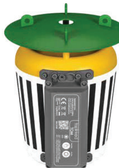
TOM im Einsatz an einer Motten-trichterfalle: Die Kamera bietet in benutzerdefinierten Intervallen Fotos vom Befall an.
